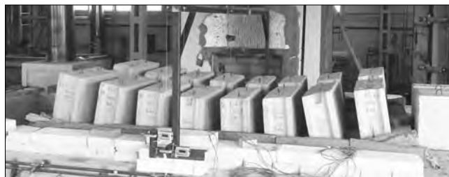
Рис. 6. Вид плит серии «А» на момент завершения испытания (113-я минута испытания)
