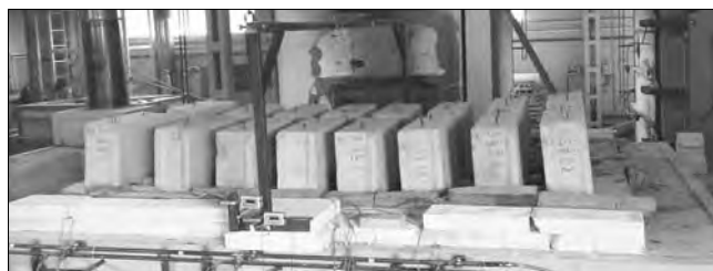
Рис. 4. Характерный вид плит с АСК на начальной стадии огневого испытания
