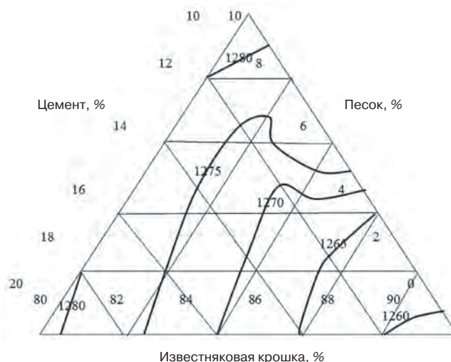
Рис. 1. Диаграмма линий равного уровня насыпной плотности смеси сухих сырьевых компонентов в зависимости от их соотношения Fig. 1. Diagram of lines of equal level of bulk density of a mixture of dry raw materials components depending on their ratio
